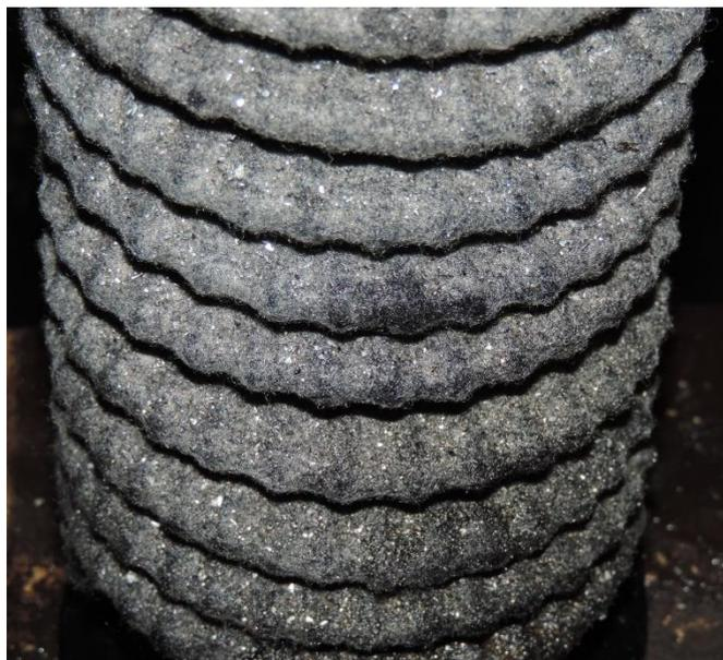
Рисунок 4 – Фильтр грубой очистки смазочного материала, покрытый металлической стружкой
