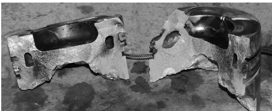
Рисунок 3 – Фрагменты разрушившегося поршня
