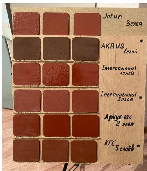
Рисунок 1 – Стенд для проверки образцов лакокрасочных покрытий на атмосферостойкость
